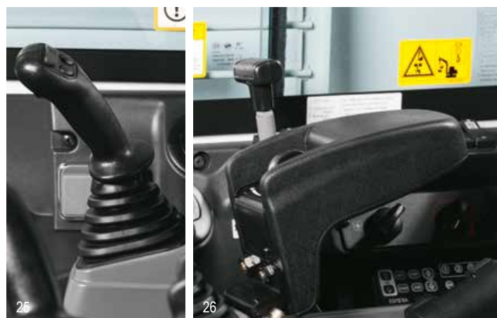
ERGONOMICZNIE ROZMIESZCZONE JOYSTICKI I PODŁOKIETNIKI Z REGULACJĄ WYSOKOŚCI ORAZ ZINTEGROWANYM REGULATOREM PRĘDKOŚCI OBROTÓW SILNIKA
