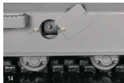
CAŁKOWICIE ZAUTOMATYZOWANE HYDRAULICZNE NAPINANIE GĄSIENIC
